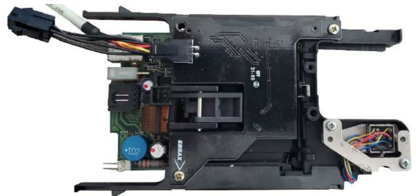
Figura 14 - Sensor Óptico instalado en el lector
