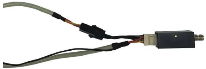
Figura 18 - Conexión de los cables al Sensor de Masa
