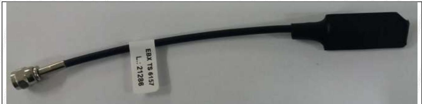
EBX TS 6157 - Antena del sensor - Conector SMA
